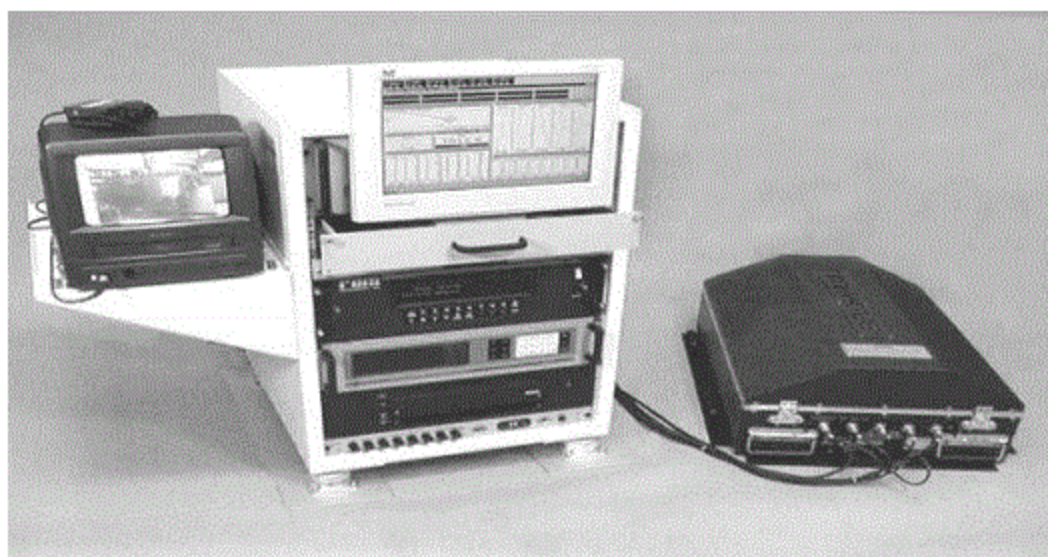
图 1-1 GR-820 型航空地球物理综合测量系统(美国产)
