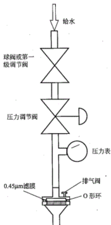
图 A.1 SDI 测试装置示意图
