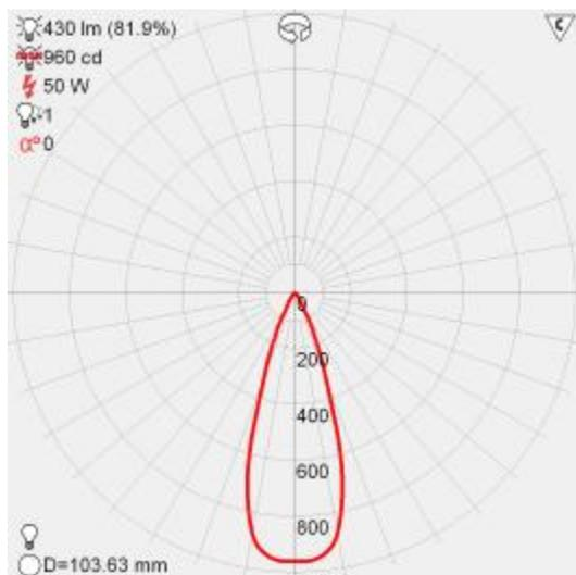
各灯具在与向下垂线成  $85^\circ$  和  $90^\circ$  方向间的最大平均亮度为  $0 \text{ cd/m}^2$ ，本项目中夜景照明灯具满足眩光限制要求。
