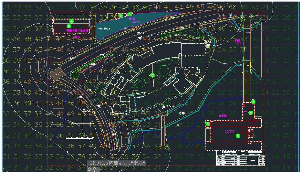
参评建筑附近区域 1.5m 高度处声压级平面分布图（夜间）
