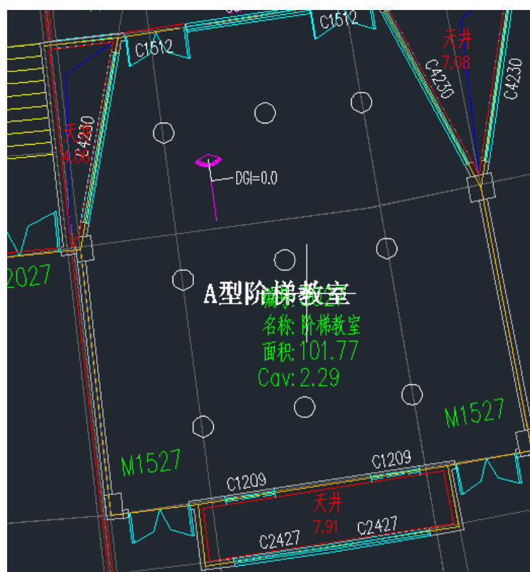
图 7 导光管+天井高窗教室布置
