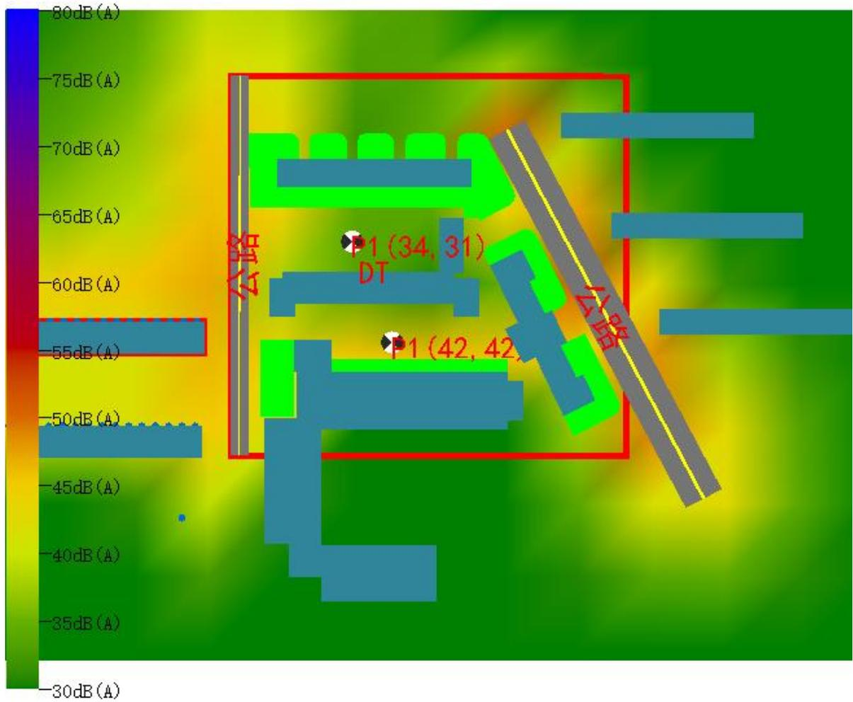
图 4.1-1 场地 1.5m 高度处声压级分布图（昼间）
