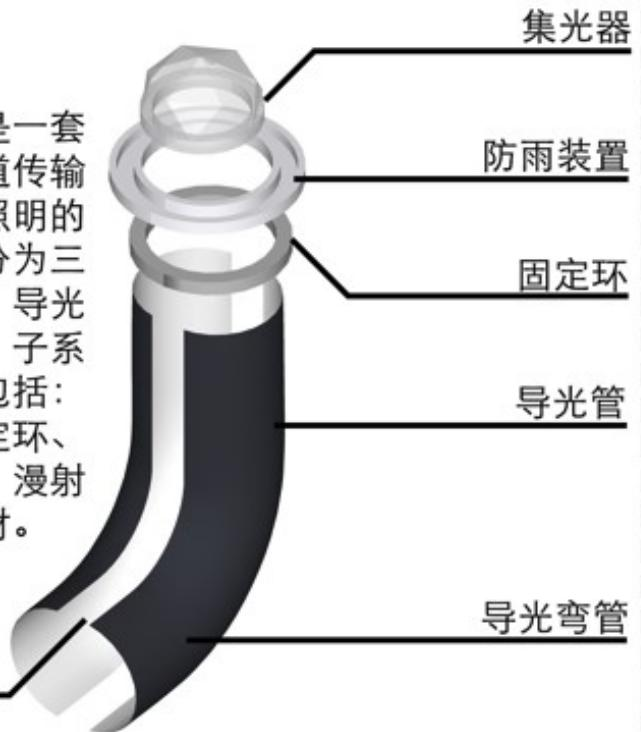
光导管：即导光管采光系统，是一套采集天然光，并经管道传输到室内，进行天然光照明的采光系统。工作系统分为三个子系统：采光系统、导光系统和漫射系统组成。子系统中含有的主要部件包括：采光罩、防雨帽、固定环、直筒、弯管、延长管、漫射器、装饰片及其他辅材。
