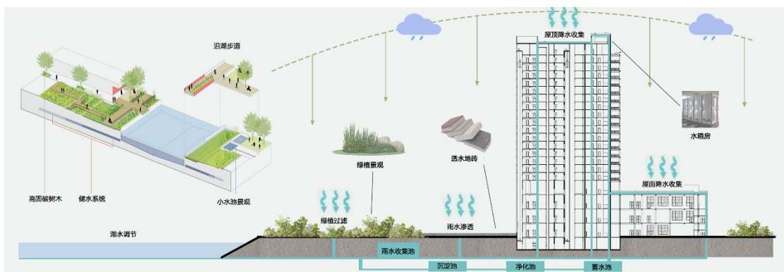
通过设置上述的雨水收集过滤系统，可以收集雨水，并对雨水进行多次沉淀、过滤，以获取较洁净的雨水，实现雨水的循环利用；通过设置具有第一沉淀件和第一储水件的沉淀装置，雨水可以在进入第一沉淀件后进行沉淀，经沉淀后的雨水进入第一储水件进行再次沉淀，经再次沉淀后的雨水进入过滤装置进行过滤，可以对雨水进行多次沉淀，可以获取较纯净的雨水，满足高质量过滤雨水的需要，实现雨水的循环利用。
