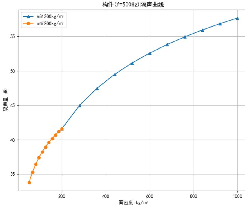
图 4-5 构件 500Hz 隔声曲线
