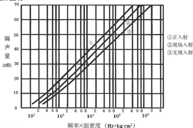
图 4-4 由质量控制的柔性板的隔声量
