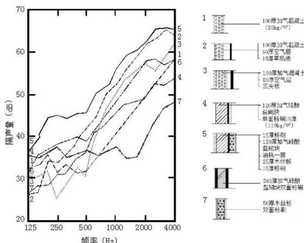
图 4-3 改善多孔材料的隔声特性实例
