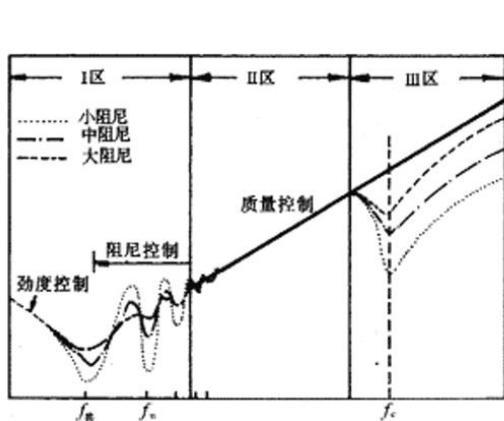
图 4-2 单层匀质墙典型隔声频率特性曲线
