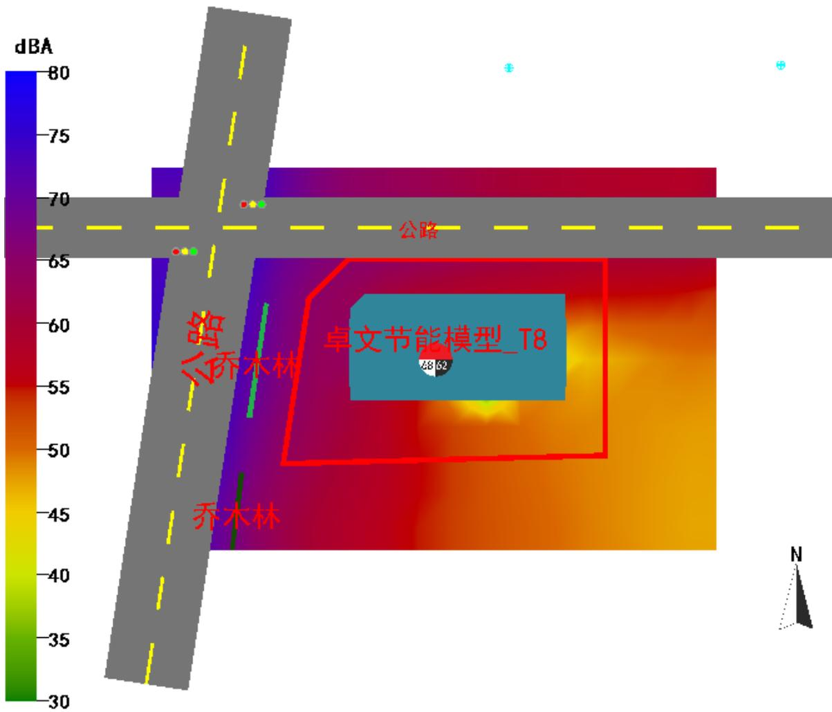
图 5-2 场地 1.5m 高度处声压级分布图 (夜间)
