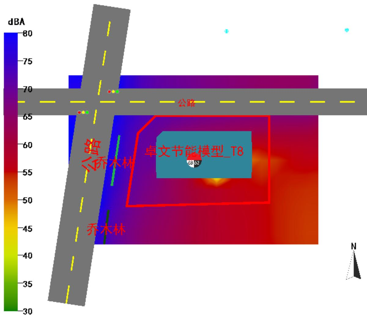
图 5-1 场地 1.5m 高度处声压级分布图 (昼间)
