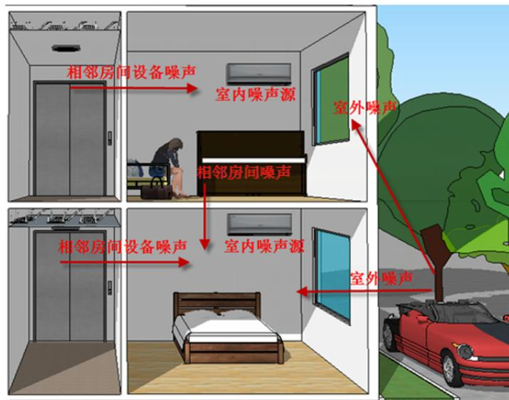
图 4-1 室内噪声声源传播示意图
