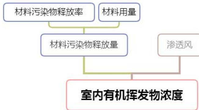
图 4-1 计算流程图
