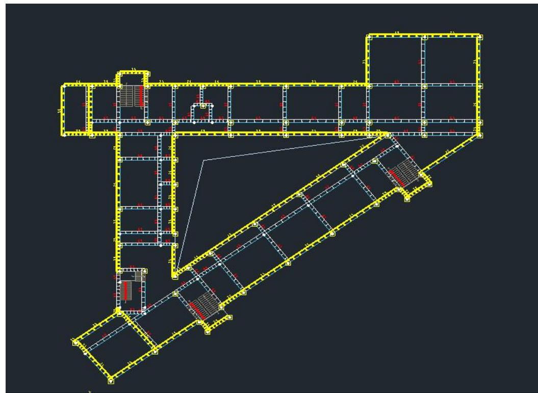
黄线外墙恒载（7.5kN/m）
