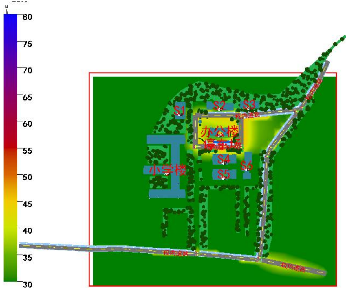
图 5- 3 场地 1.5m 高度处声压级分布图（夜间）
