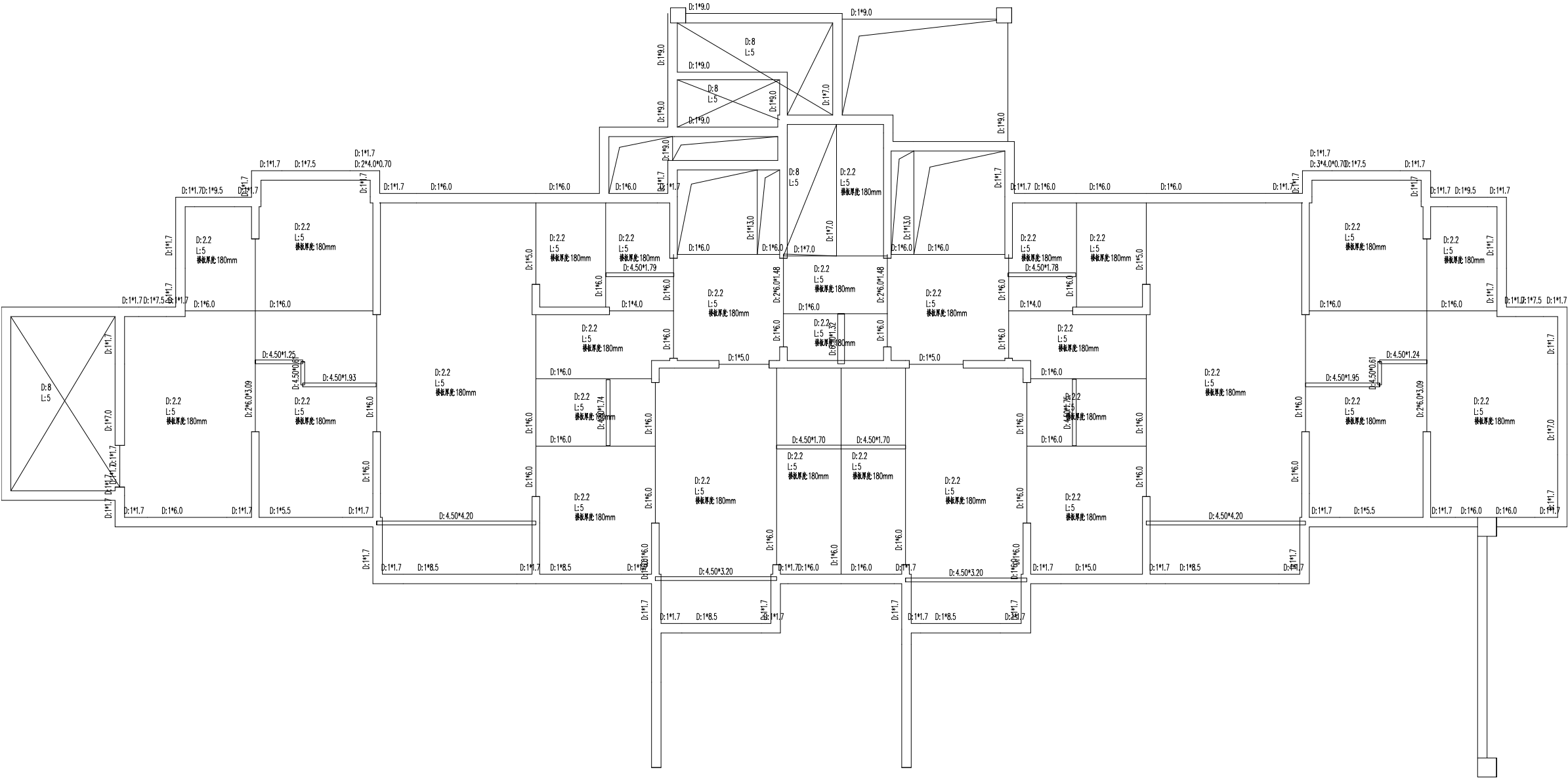
图 2 层(第 2 标准层)楼、地、柱、节点荷载平面简图 [单位:kN/m²] [ D:恒载 L:活载 R:人防荷载 [ ]为分房间荷载 ]
